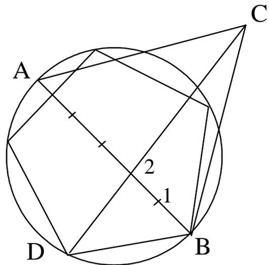
Die Skizze erläutert die Konstruktionsbeschreibung für das im Kreis einbeschriebene reguläre Fünfeck. Beim Ausprobieren der Methode stellt man fest, dass dieses Verfahren für  $n = 3, 4, 6$  das exakte  $n$ -Eck liefert. Um die Genauigkeit des Verfahrens für andere  $n$  zu untersuchen, beschreibe man die Abhängigkeit der Seitenlänge  $\overline{BD}$  vom Radius  $r = \overline{AB}$ .
